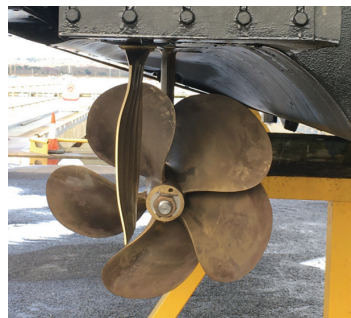
Gouvernail aligné sur la vitesse (GAV) installé pour les essais en mer
